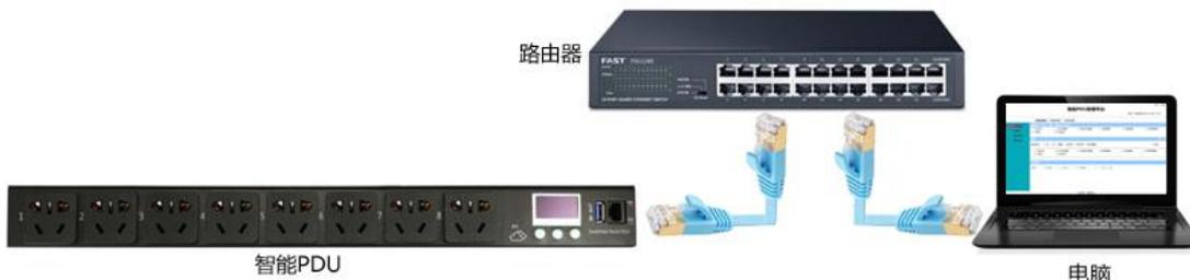
（3）使用专用网关硬件（自带管理系统），将网关、智能 PDU、电脑同时接入路由器，通过浏览器访问网关的 IP 地址登录管理界面实现多台 PDU 集中管控。网关产品目前仅限 API 系列产品，一台网关管理产品理论可管理 254 台智能 PDU。配合无线路由可实现手机 web 管理。
