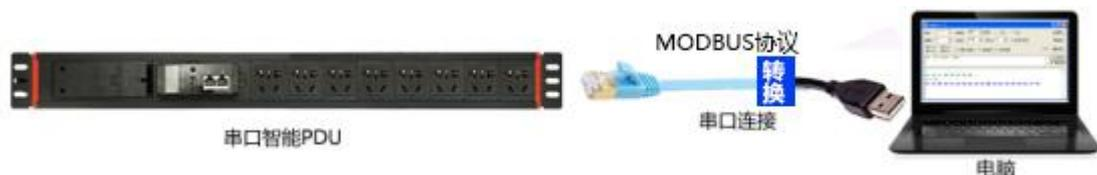
多台串口 PDU 可以通过 RS485 进行级联管理。
